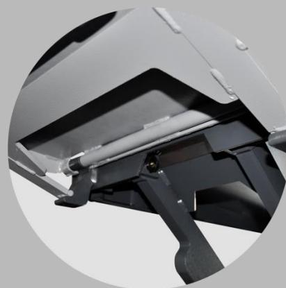
Широкие упоры заездных трапов предназначены для работы с длинными и тяжелыми автомобилями
