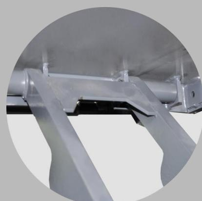
Конструкция оси платформы с
